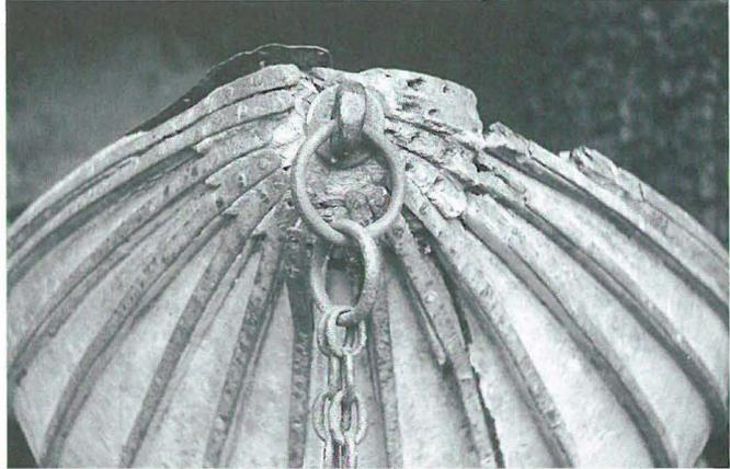
Abb. 5 *In der Vorderansicht ist zu sehen, wie das Kopf Brett den Verlauf der Planken aufnimmt. Die Unterkanten der Planken sind durch die eiserne Wallschiene abgedeckt.*
