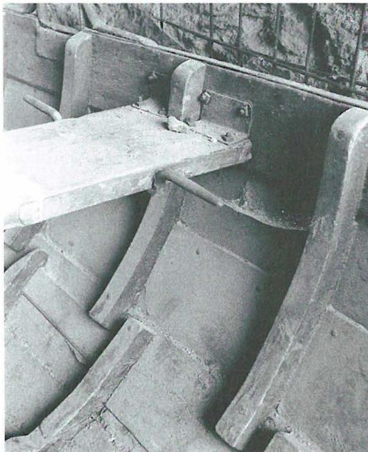
Abb. 12 Winkelleisen verbinden die Duchten mit der Bordwand. Unter der Ducht liegen die Semmnägel zum Festmachen der Schaluppen. Zu erkennen sind auch die Nieten an den Enden der Bodenwrangen sowie der Spanten.
