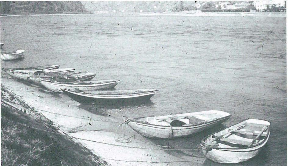
Abb. 1 Lotsenschaluppen am Rheinufer in St. Goar. Die vorderen vier Schaluppen sind aus Eisen, die beiden folgenden aus Holz. (Foto: Striedelmeyer, 1938)
