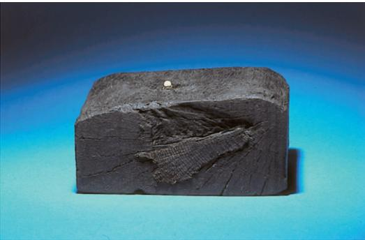
Abb. 2 Ein Stück aus der Kielplanke eines römischen Flußschiffes aus Mainz mit einem nur noch kleinen inneren Bereich kaum abgebauten Holzes.
