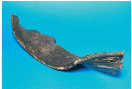
Abb. 20 Stück einer Planke von einem Bootsfund – ohne Konservierung getrocknet. (Foto: E. Laska/DSM)
