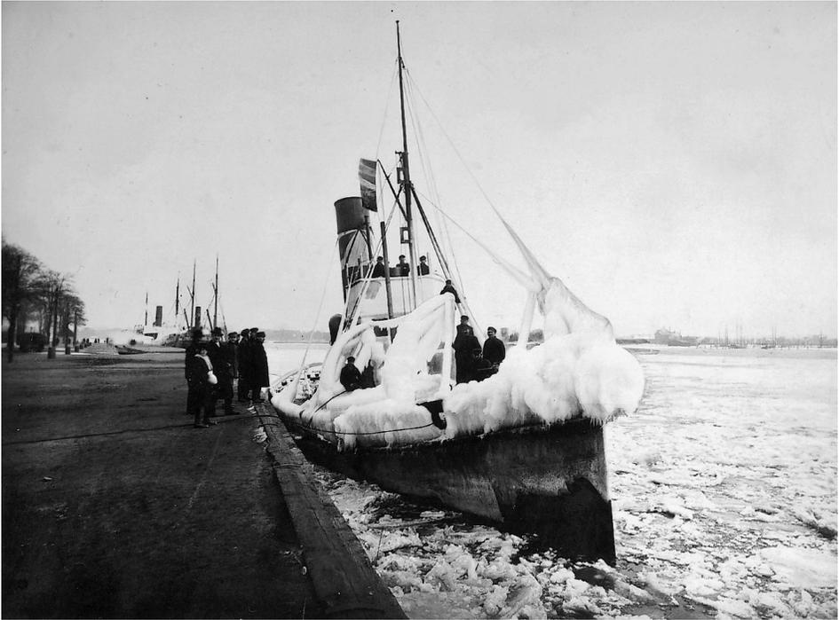
Abb. 3 Nach dem Ersten Weltkrieg setzte sich der Schlepplichterdienst der SGUW in die Ostsee zunächst fort. Im Januar 1920 musste der Schleppdampfer BRAKE (500 PSI, erbaut 1908 beim Bremer Vulkan, Bremen-Vege-sack) mit schwerer Vereisung Swinemünde als Nothafen anlaufen. (Archiv URAG)
