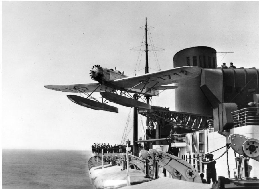
Am 22. Juli 1929 startete erstmalig eine Heinkel He 12 etwa 400 km vor New York von der Katapultanlage der BREMEN. Nach 2,5 Stunden erreichte das Flugzeug sein Ziel. In den folgenden Jahren wuchsen die Flugdistanzen sogar auf bis zu 1 500 km. 1935 wurden die Flüge allerdings eingestellt, da die Lufthansa Flugverbindungen über eigene Katapultschiffe eingerichtet hatte. Das Katapult an Bord der BREMEN wurde ausgebaut und durch eine Garage ersetzt, um der steigenden Nachfrage nach Transportraum für die Autos der Passagiere gerecht zu werden. Foto: Lufthansa / Archiv DSM
