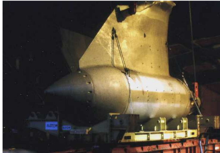
Für den Einbau bereitgestellter Pod-Antrieb. Foto: Klaus-Peter Kiedel
