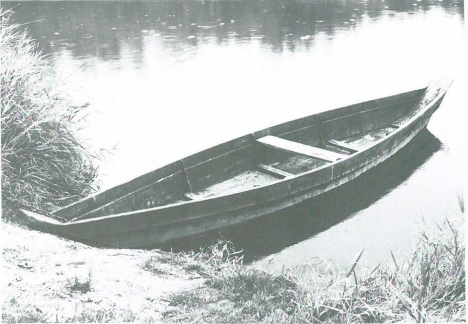
Abb. 9 »Szkutka« mit Metallversteifungen aus Księżce Młyny. Diese Variante ist heute die häufigste
