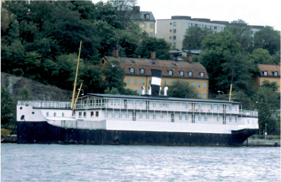
Abb. 8 Das 1920 gebaute, ursprünglich dänische Betonschiff BARTELS lag jahrelang, zum Wohnschiff umgebaut, am Södra Mälarstrand in Stockholm. (Slg. Holger Munchaus Petersen, Kopenhagen)
