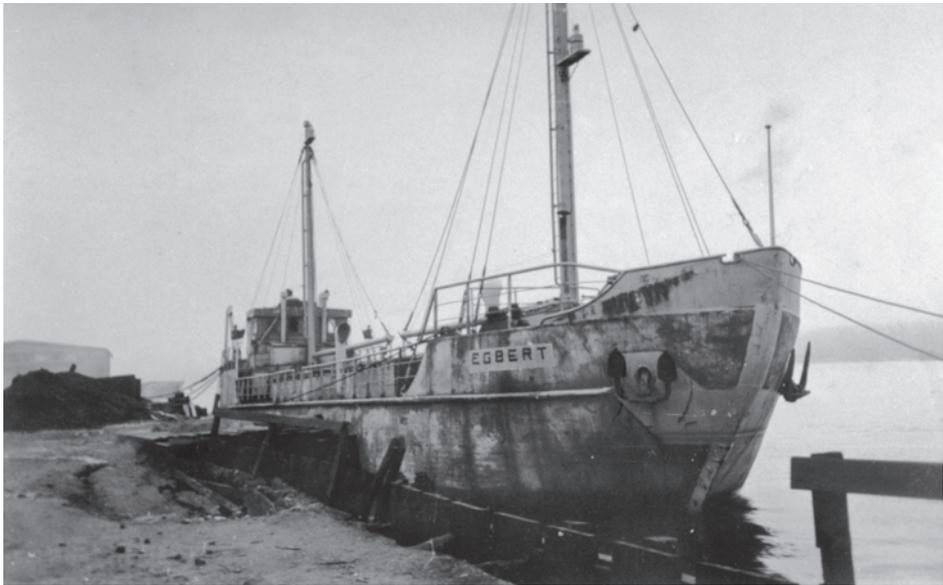
Abb. 32 MS EGBERT war ein 300-t-Beton-Küstenmotorschiff vom Bauplatz Rotterdam-Merwehaven, Aufnahme 1945. (Archiv DSM)
