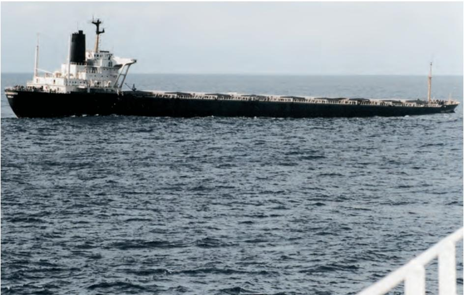
Abb. 4–5 Markante Trimmlagen des Bulkcarriers.
