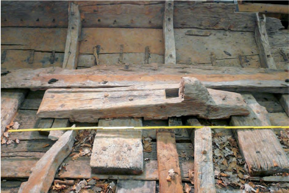
Abb. 11 Bordwand mit Reparatur und Mastschuh bei Kahn B. (Foto: R. Mücke)
