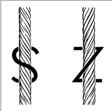
Abb. 21 Schema der S- und Z-Zwirnung.
