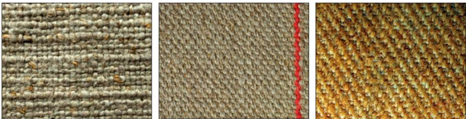
Abb. 22–24 Leinwandbindung (links), Segeltuchbindung (Mitte) und Köperbindung (rechts).
